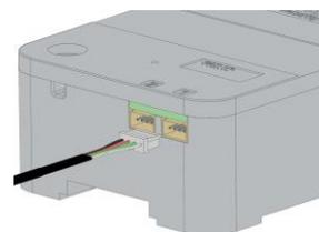
La versione Push & Pull (T5301/MP) viene fornita di default con l'opzione RCS per richiusura chiavistello comandata da segnalazione esterna (ad esempio un contatto catenacci) che permetterà di evitare che il motore venga azionato quando i catenacci non sono ancora espansi. Si raccomanda di utilizzare correttamente questa segnalazione per evitare danneggiamenti al motore.
