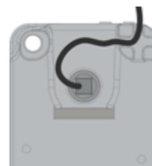
Collegare il cavo all'ingresso "1" della serratura accertandosi che sia completamente inserito e bloccato. Qualunque interfaccia di allarme o porta batteria deve essere connesso al connettore "2" della serratura. Per rimuovere il cavo, portare il connettore verso l'alto ed estrarlo con cura.
